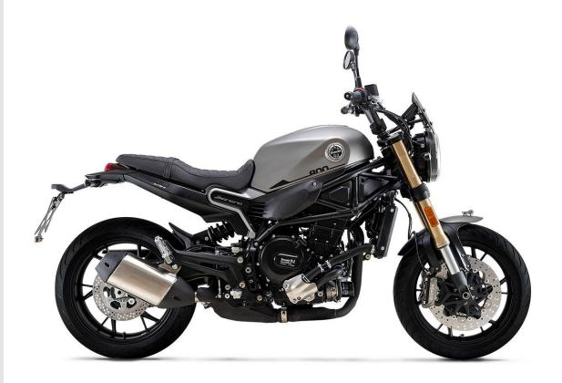
Motor : 2-Zylinder-Reihenmotor, DOHC, flüssigkeitsgekühlt
