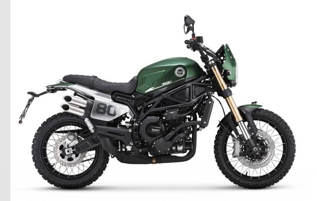
Motor : 2-Zylinder-Reihenmotor, DOHC, flüssigkeitsgekühlt
