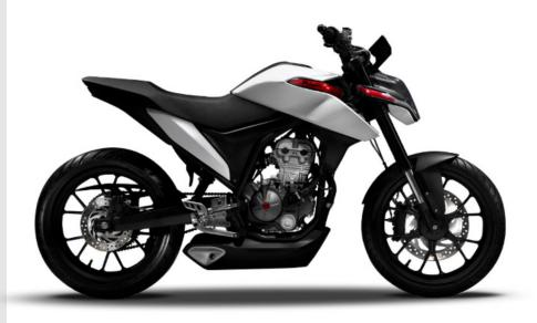
Motor : 1-Zylinder-Motor, 4-Takt, DOHC, flüssigkeitsgekühlt
